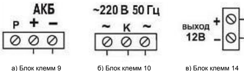
Рисунок 5 – Маркировка блоков клемм 9, 10, 14 ББП
