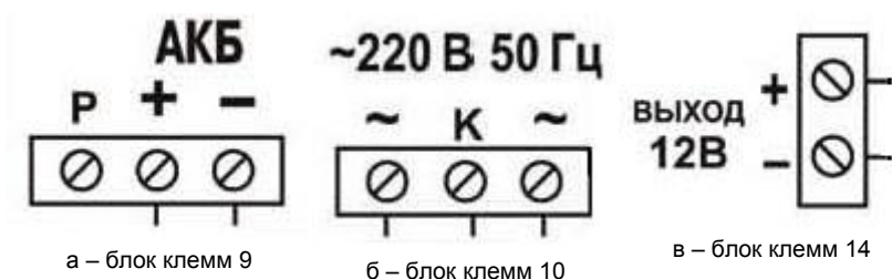
Рисунок 3 – Маркировки блоков клемм 9, 10, 14 ББП
