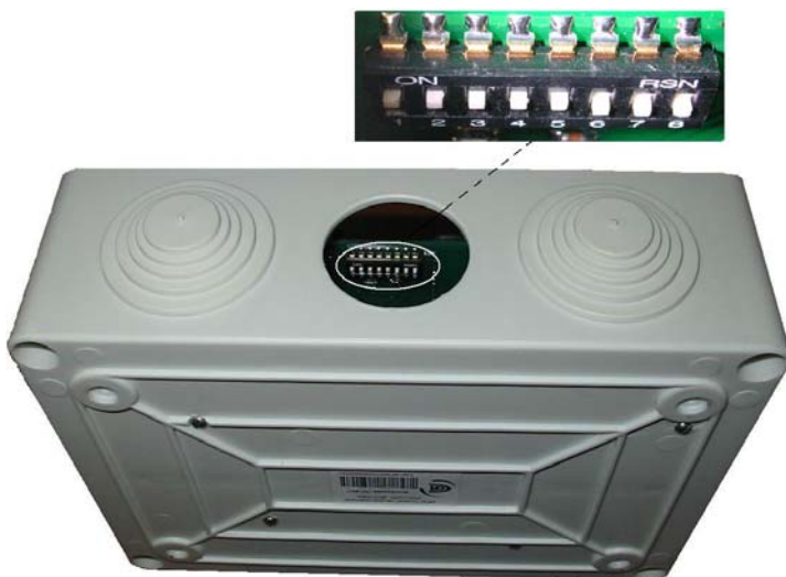
Рисунок 5 - DIP-переключатели контроллера доступа
