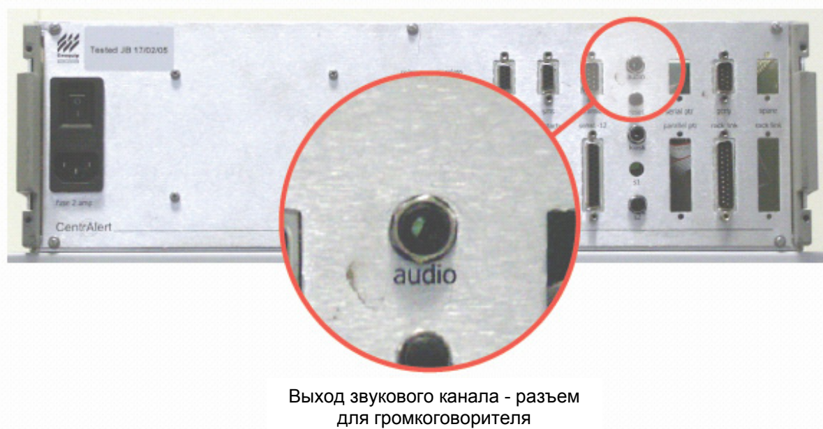
Рис. 4.9. Разъем для подключения внешнего громкоговорителя
