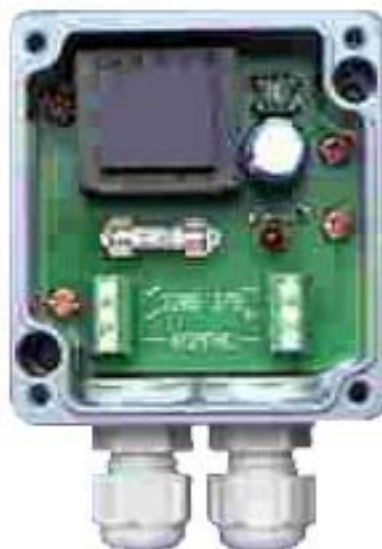
Рис. 8.2. Внешний вид блока питания со снятой крышкой.
