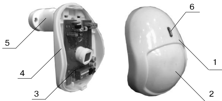
Рис.21 Конструкция ИК-А
