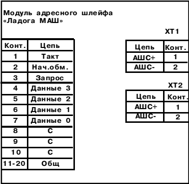
Рис. 17 Схема электрическая общая МАШ
