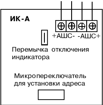
Рис. 23 Схема внешних подключений ИК-А
