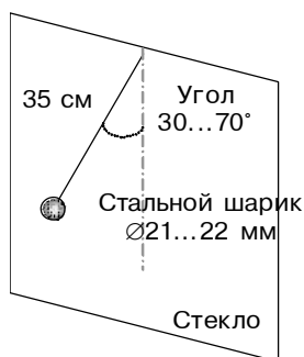
Рис. 35 Нанесение имитационного удара по стеклу при настройке извещателя
