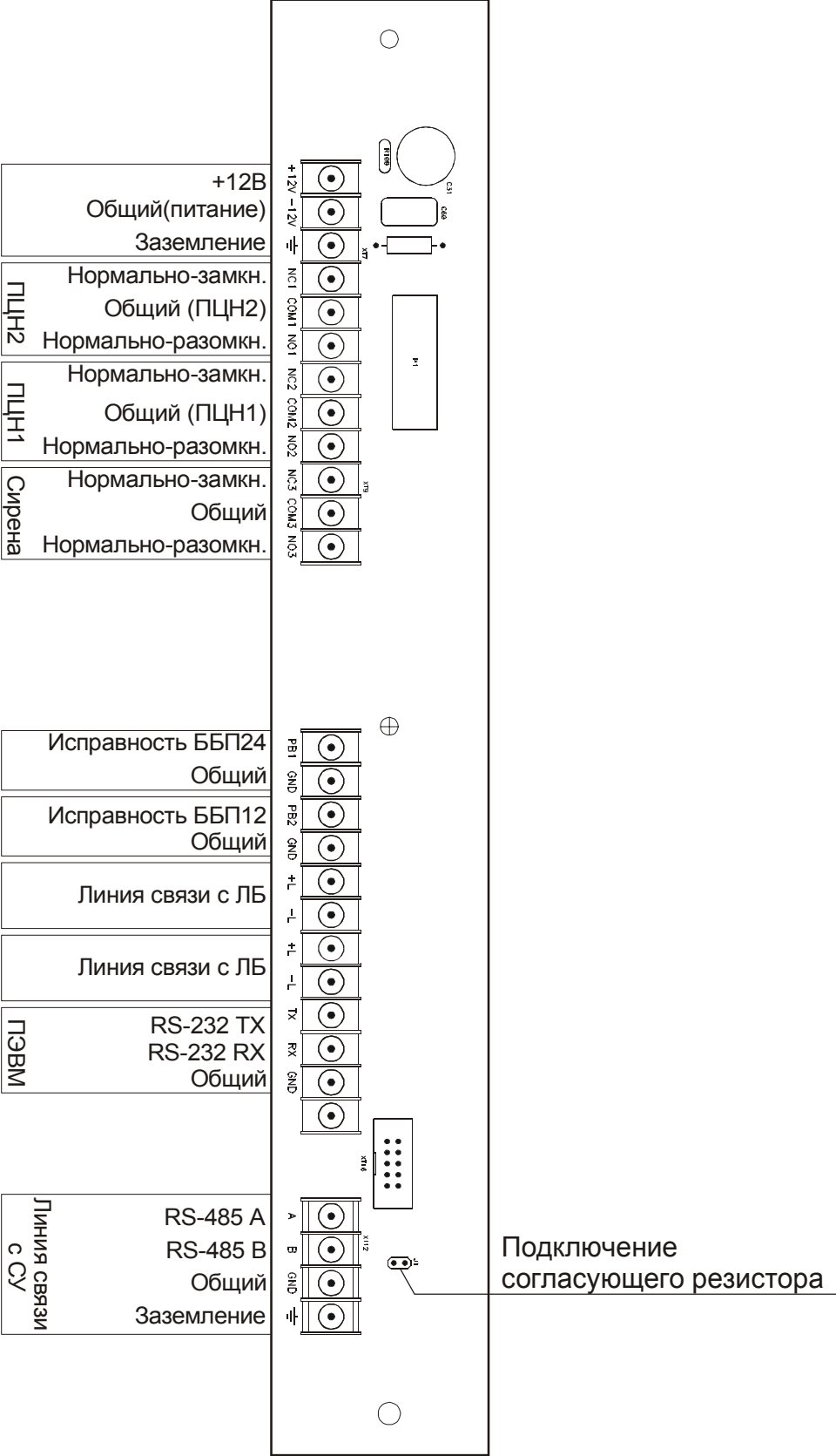
Рис. 8 Схема подключения БЦП
