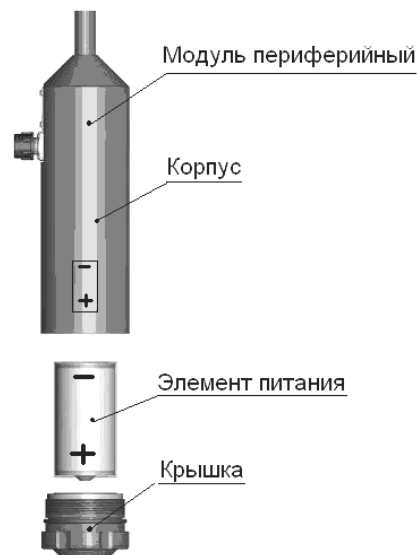
Рисунок 2 – Установка элемента питания в МП
